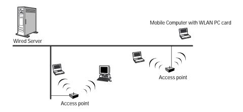
FIGURE 2. TYPICAL WLAN CONFIGURATION
