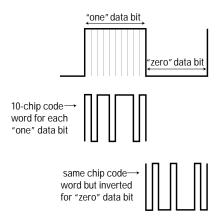
FIGURE 8. DIRECT SEQUENCE SPREAD SPECTRUM
